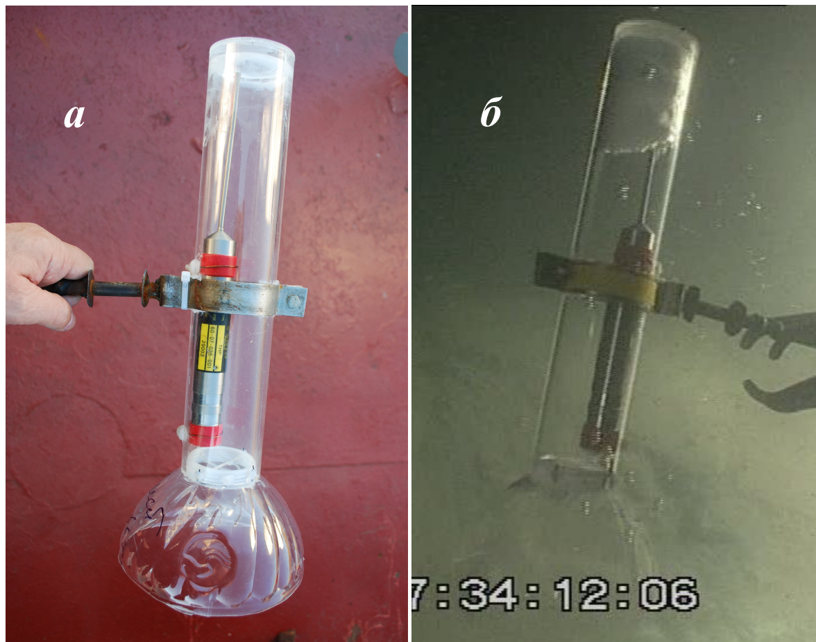
Рис. 3. а - контейнер «Термо» перед погружением. Внутри закреплён термодатчик ТНР. Чувствительный элемент датчика находится в середине штыря. б - контейнер «Термо» в процессе сбора метановых пузырей. В верхней части контейнера из отобранных пузырей образовалась твёрдая гидратная пена. Цифры в нижней части кадра – фрагмент рабочего тайм-кода.
